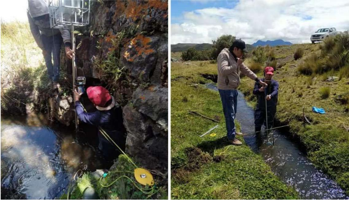
Figura 1 Comparación de medición de molinete FONAG con molinete ultrasónico de INMAHI. Estación ATP01HI01.
