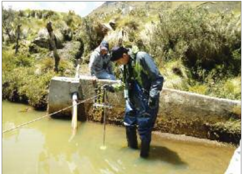
Técnicos de FONAG en tareas de medición de caudales para el inventario participativo de usos del agua en la sub cuenca del Pita.
