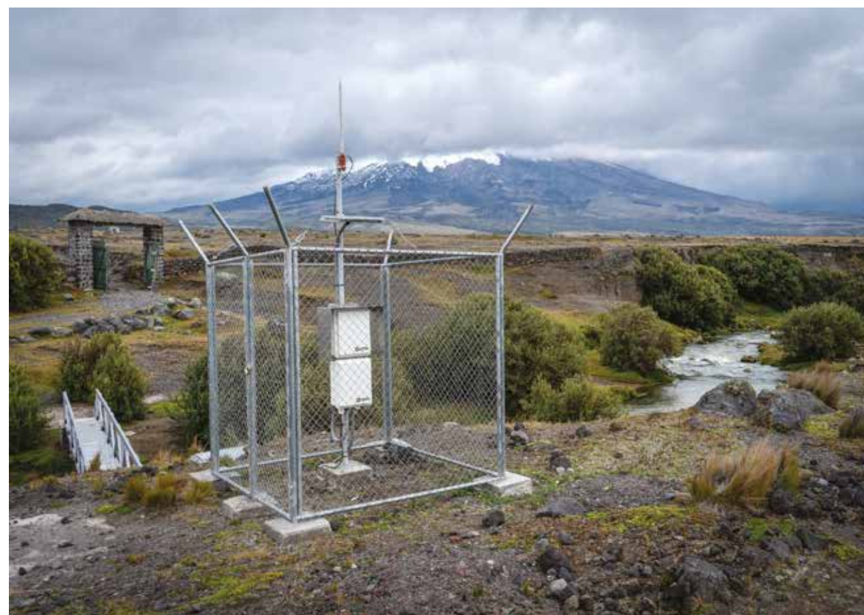
Estación de Monitoreo Hidrometeorológico, ACH Alto Pita
